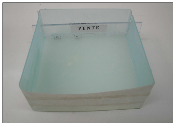
Figura 10: Gel de maisena com o pente acoplado.
