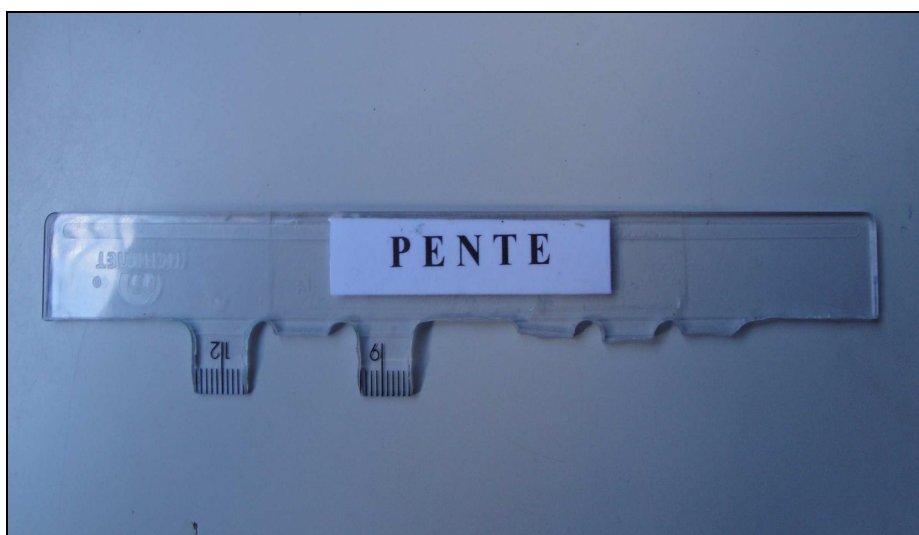
Figura 3: Pente formador de poços no gel.
